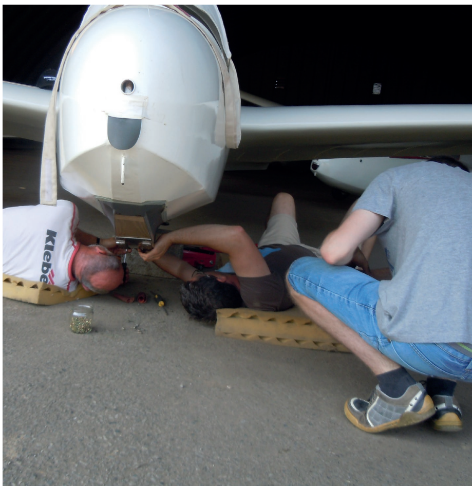
Het vervangen van de ijzeren latten onderaan de Ka 13
